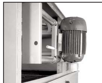
电动机检修门
