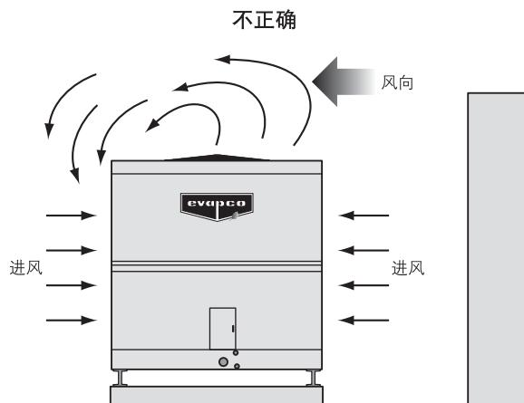
图24 - 机组顶部低于墙顶时的风影响
