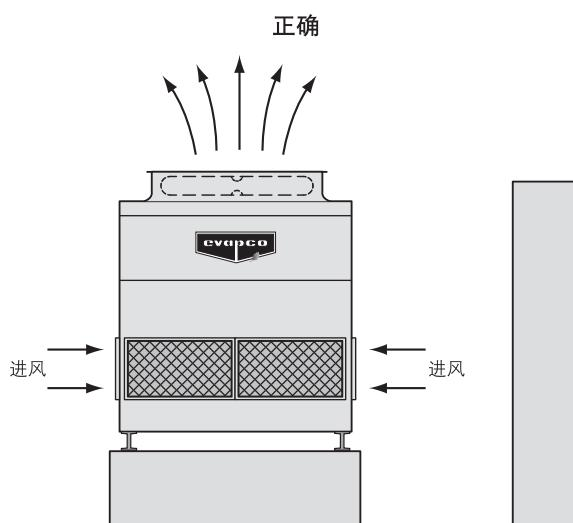
图3 - 将机组抬高使其顶部高出墙顶
