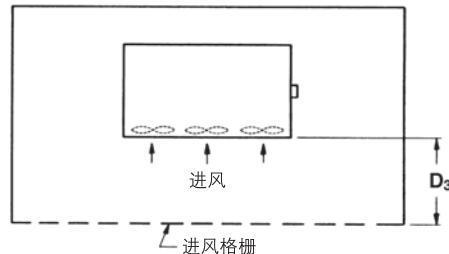
图47 - 前方有格栅的格栅墙围挡物
