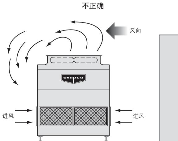
图2 - 机组顶部低于墙顶时的风影响
