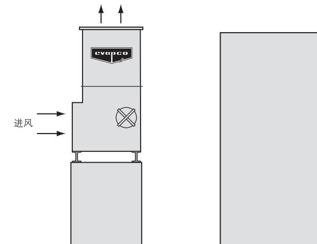
图35 - 将机组抬高使其顶部高出墙顶
