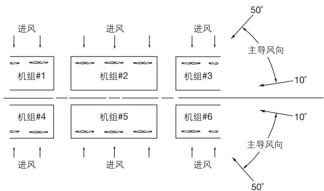
图45 - 大型安装工程 - 机组背靠背
