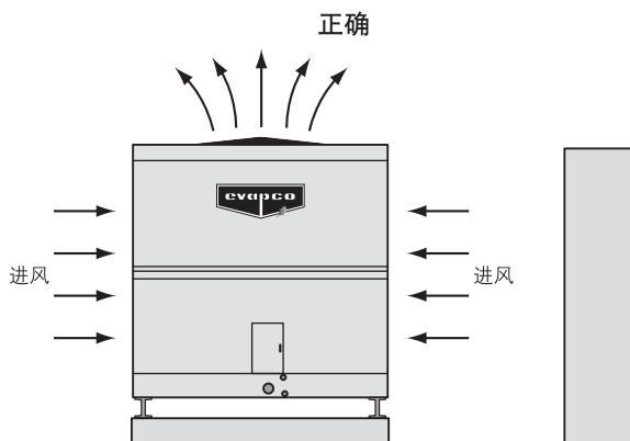
图25 - 将机组抬高使其顶部高出墙顶
