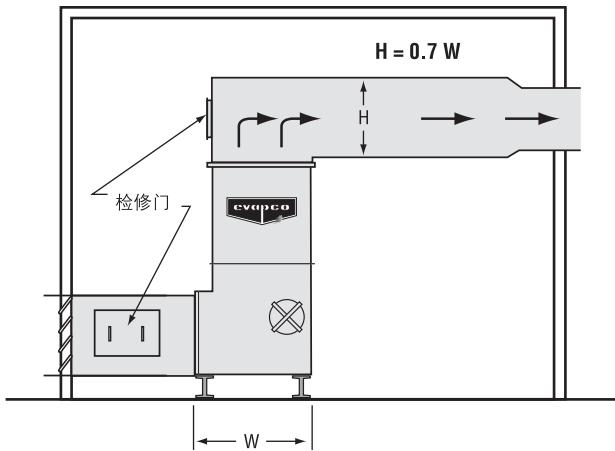
图51 - 带有通风道的室内安装
