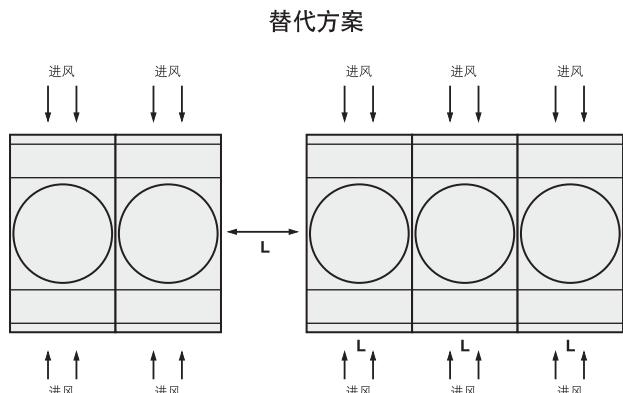
图28a - 多台机组端面对端面安装
