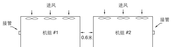
图41 - 多台机组安装 - 端部对端部
