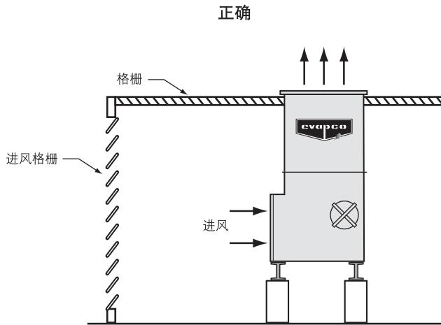
图49 - 顶部有格栅的围挡物
