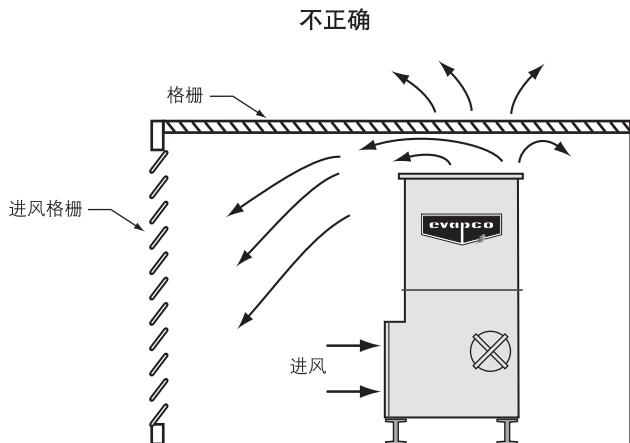
图48 - 顶部有格栅的围挡物
