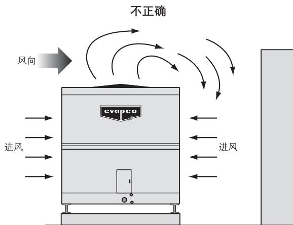
图23 - 机组顶部低于墙顶
