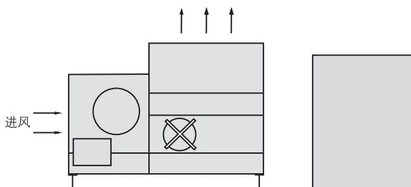
图37 - 安装地靠近墙时机组的最佳朝向
