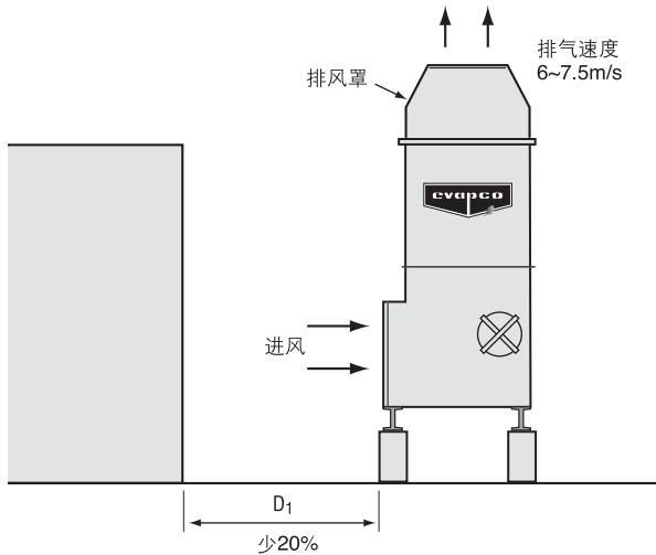
图39 - 采用了锥形排风罩的安装
