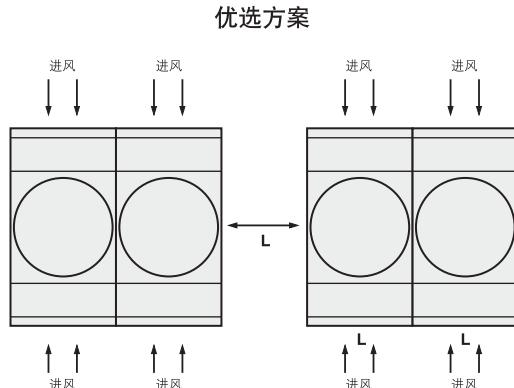
图28 - 多台机组端面对端面安装
