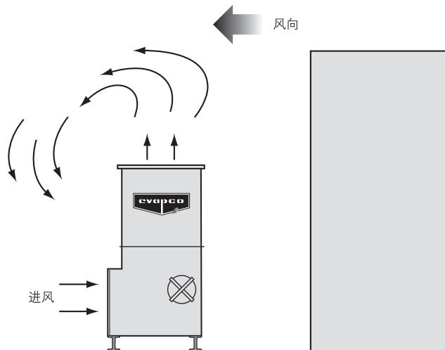
图34 - 机组顶部低于墙顶时风的影响
