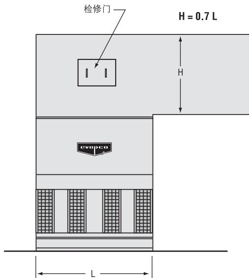
图52 - 带有通风道的室内安装
