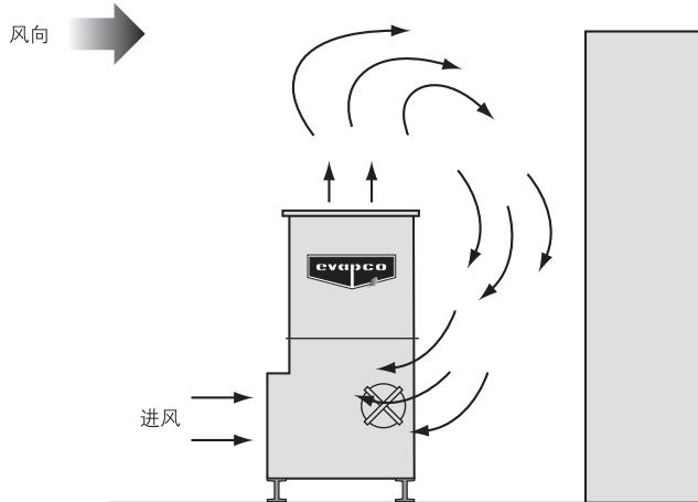
图33 - 机组顶部低于墙顶的安装
